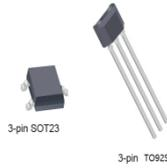
HM465是一款低功耗高灵敏单极性霍尔开关芯片，采用CMOS工艺设计生产。该芯片器件内部集成了电压调节器、霍尔电压发生器、小信号放大器、斩波稳压器、施密特触发器和CMOS输出驱动器。该芯片温度稳定性好、抗应力强、灵敏度高等特点，工作电压在2.5V-5.5V。提供TO-92S直插封装，贴片SOT23-3L封装，且封装都符合RoHS环保标准。
